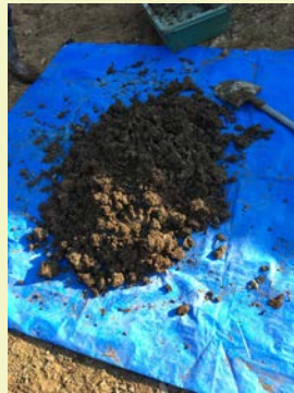
⑤改質後 セルドロン混合後の堆積汚泥はパラパラの状態になります。
