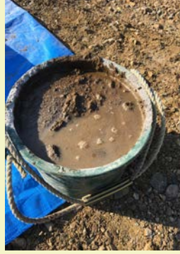
③堆積汚泥 池底の堆積汚泥を救い上げてセルドロンの配合試験を行います。
