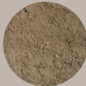
セルドロン攪拌直後良質土へ
