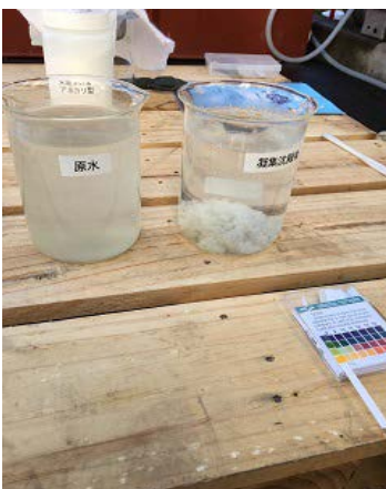
コンクリート圧送車の洗い水配合試験
