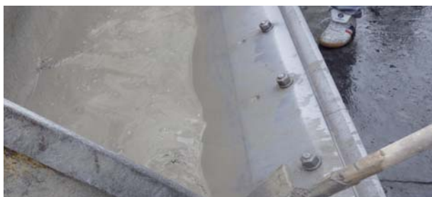
生コン工場が発生するスラッジ水
